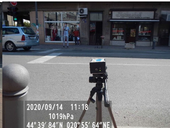
Слика 10. Уређај за аутоматско бројање саобраћаја на ММ 4
