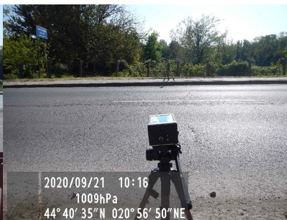
Слика 24. Уређај за аутоматско бројање саобраћаја на ММ 11
