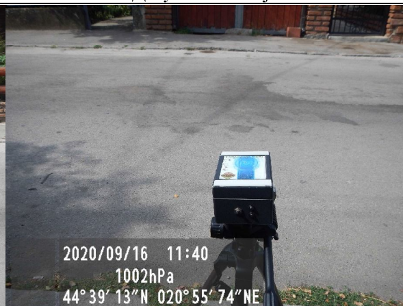
Слика 22. Уређај за аутоматско бројање саобраћаја на ММ 10
