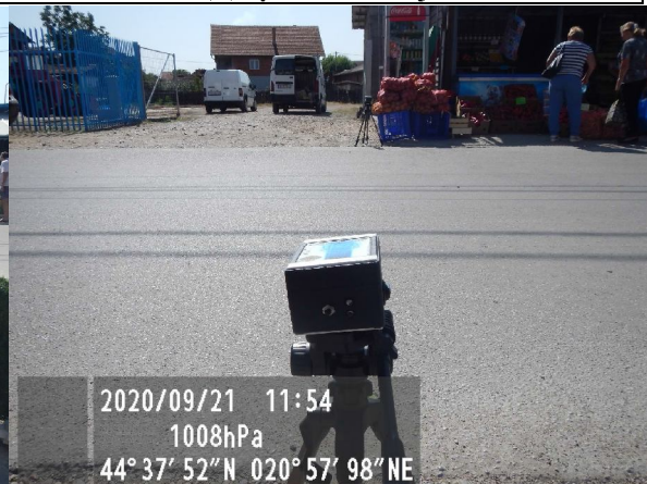
Слика 16. Уређај за аутоматско бројање саобраћаја на ММ 7
