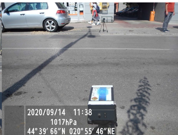
Слика 8. Уређај за аутоматско бројање саобраћаја на ММ 3
