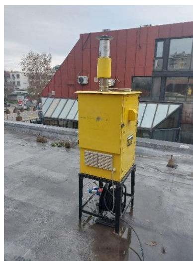
Слика 5. Изглед мерног места ММ 375-25 S2_Центар за културу у Смедереву (PM 10 )
