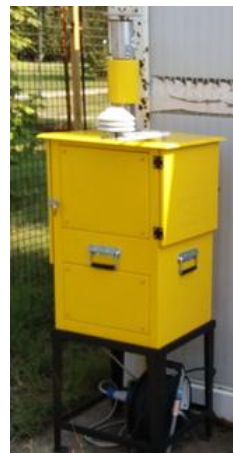
Слика 7. Изглед узоркивача LIFETEK PMS
